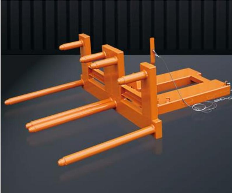
Mit dem Fasswender ist das Kippen und Aufstellen von einem oder zwei Fässern über den Seilzug komfortabel vom Führerhaus aus zu bewerkstelligen. Zum Abkippen des liegenden Fasses ist der Seilzug zu bedienen. Zur Aufnahme von stehenden Fässern wird der Fasswender senkrecht aufgesetzt und das Fass mit dem Stapler geneigt. Der Verriegelungsmechanismus rastet automatisch bei einem Neigungswinkel von 8° ein. Einfach die Staplerhydraulik anheben und das Fass verladen.
